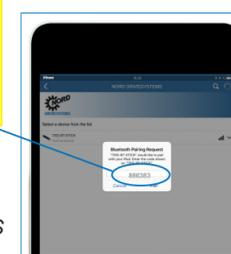
Se for solicitado um PIN, use os últimos 6 dígitos do número de identificação na placa de identificação do NORDAC ACCESS BT e conecte os dispositivos.
