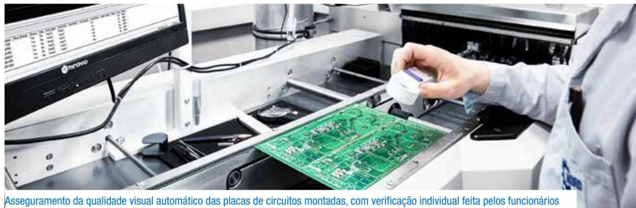
Asseguramento da qualidade visual automático das placas de circuitos montadas, com verificação individual feita pelos funcionários
