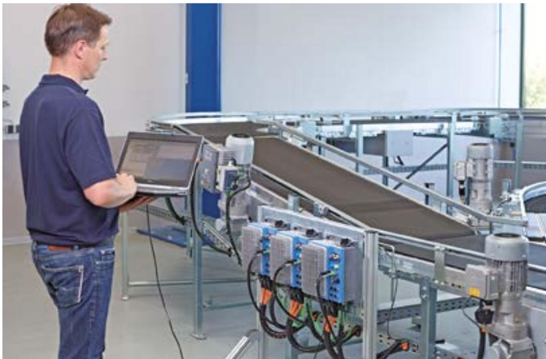
Sistemas transportadores em geral e a intralogística exigem comandos de acionamentos de simples instalação e de fácil acesso durante a operação e em caso de manutenção. O distribuidor de campo NORDAC LINK complementa o portfólio de produtos NORD, oferecendo aos clientes um comando de acionamento para instalação flexível e próxima ao motor. A tecnologia de acionamentos descentralizados reduz significativamente os custos dos equipamentos.
