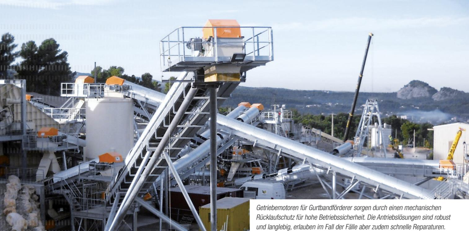
Getriebemotoren für Gurtbandförderer sorgen durch einen mechanischen Rücklaufschutz für hohe Betriebssicherheit. Die Antriebslösungen sind robust und langlebig, erlauben im Fall der Fälle aber zudem schnelle Reparaturen.
