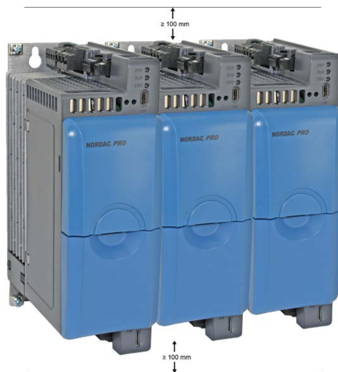
Figure 1 : Distances de montage
