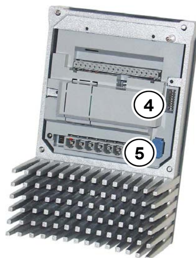
Figura 6: SK 2xxE (grandezza 1), vista interna
