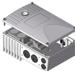
4. Monte el cárter del SK 1x0E con los tornillos existentes y la junta, así como con las arandelas dentadas y de contacto adjuntas, en la base de la caja de bornes del motor NORD. El cárter debe alinearse de tal modo que el lado redondeado apunte en hacia el escudo A del motor. Llevar a cabo la adaptación mecánica con el "kit adaptador" (📖 apartado 2.1.1.1 "Ajuste al tamaño del motor"). En caso de utilizar motores de otros fabricantes deberá comprobarse siempre su adaptabilidad.
