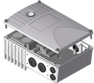
4. Auf den Klemmkastenstumpf des NORD-Motors das Gehäuse des SK 1x0E mit den vorhandenen Schrauben und der Dichtung sowie den beiliegenden Zahn- / Kontaktscheiben montieren. Das Gehäuse ist dabei so auszurichten, dass die abgerundete Seite in Richtung A-Lagerschild des Motors zeigt. Mechanische Anpassung mittels „Adapterkit“ (📖 Abschnitt 2.1.1.1 "Anpassung an die Motorbaugröße") vornehmen. Bei Motoren anderer Hersteller ist die Anbaubarkeit generell zu prüfen.
