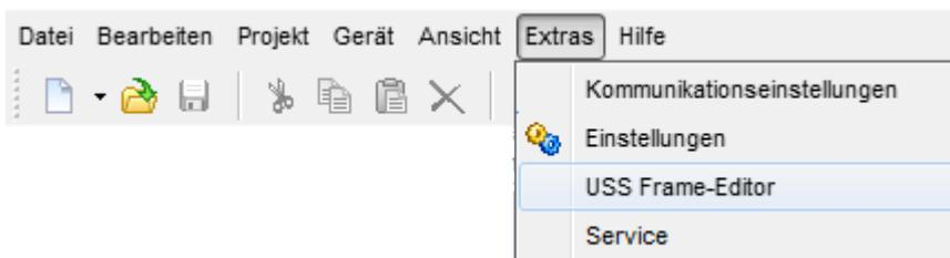
Der USS Frame Editor wurde für die Erzeugung und die Analyse von USS Telegrammen entwickelt. Er ist vollständig in die Oberfläche von NORDCON integriert und wird über den Menüpunkt "Extras/USS Frame-Editor" geöffnet. Der Editor stellt das Master und Slave-Telegramm in mehreren Ansichten dar. Über Registerkarten kann der Benutzer zwischen dem 9.1 "Master (Auftrag)" und dem 9.2 "Gerät (Antwort)" wechseln.
