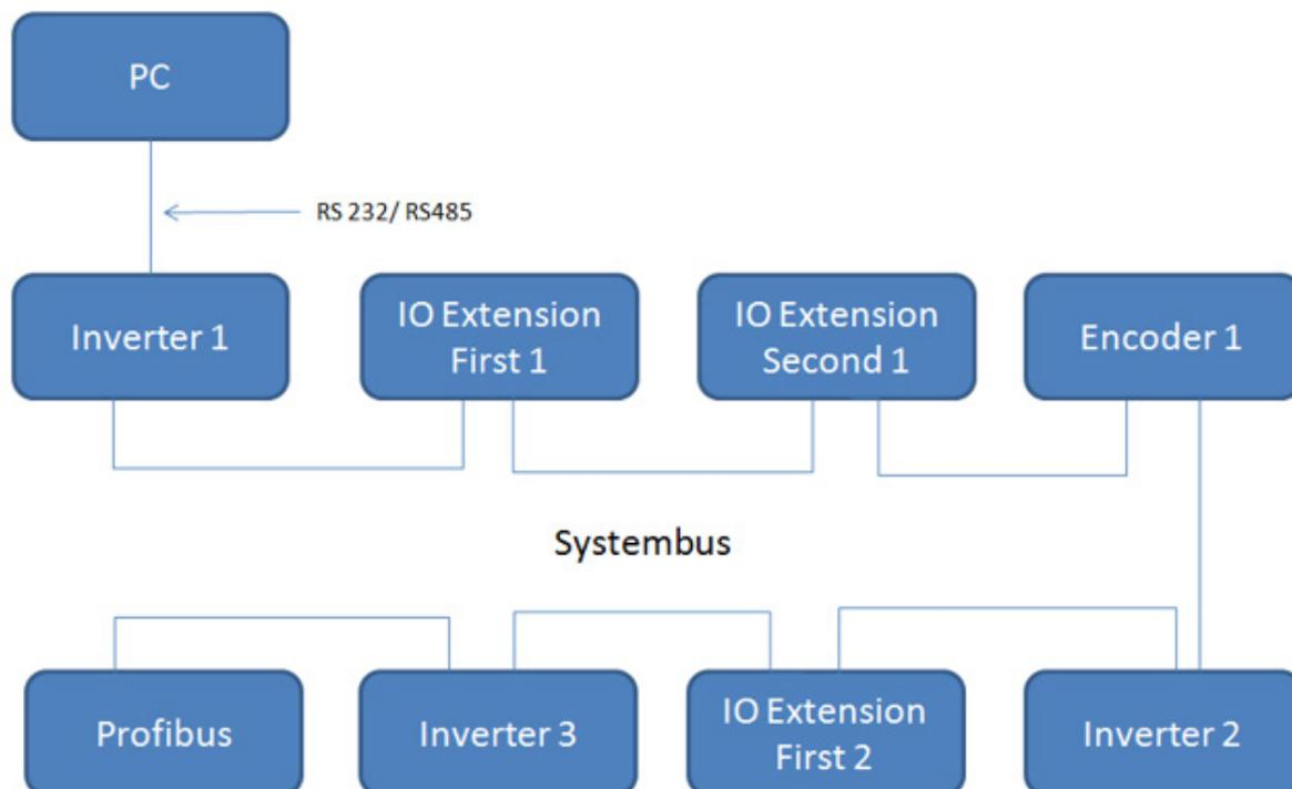
Alle am Systembus angeschlossenen NORD Baugruppen können über einen Teilnehmer mit RS232/RS485 Schnittstelle über NORDCON visualisiert und parametrierbar werden. Hierfür werden die Kommunikationsanfragen über das an NORDCON oder Firmwareaktualisierungsprogramm angeschlossene Gerät getunnelt. Für die Tunnelung der Anforderungen wird das folgende Mapping-Verfahren verwendet:
