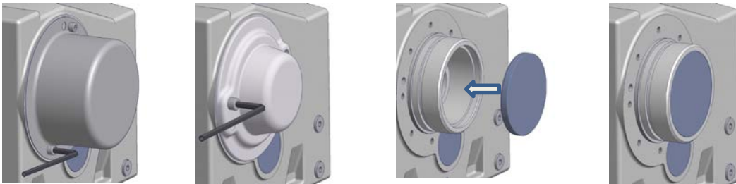
그림 14: 커버 옵션 SH, 옵션 H 및 옵션 H66 설치
