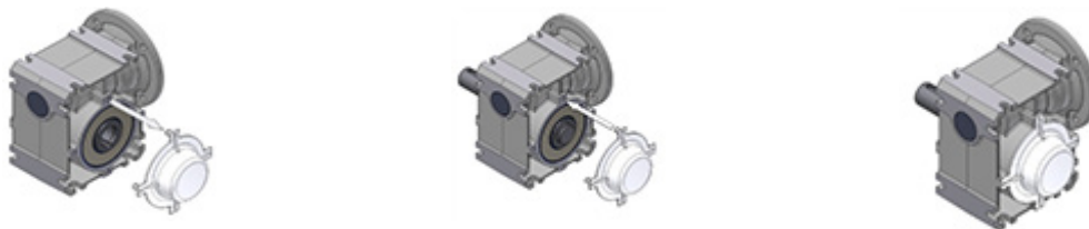
Slika 15: Demontaža i montaža pokrovne kape
