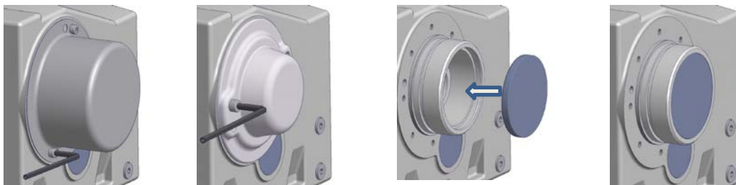
Slika 14: Montaža poklopca za pokrivanje, opcija SH, opcija H i opcija H66
