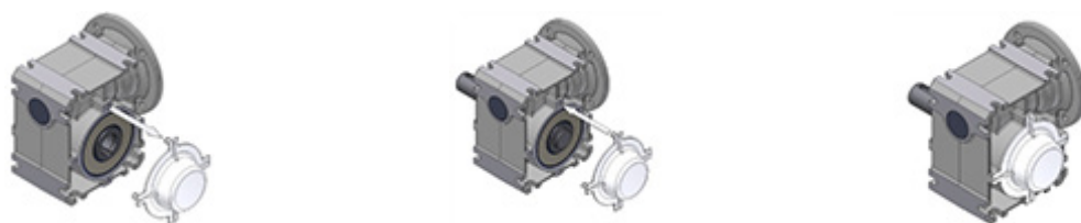
Obrázok 15: Demontáž a montáž krycieho veka
