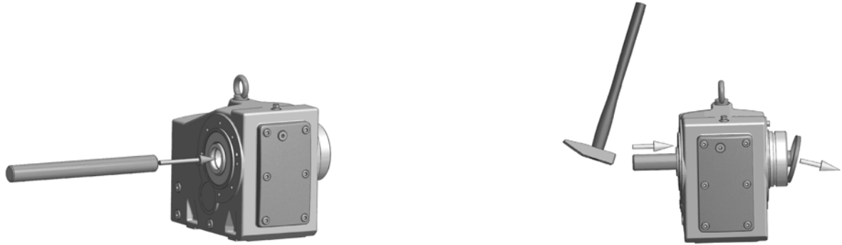
Kuva 5: Tehdasasennetun sulkutulpan poistaminen
