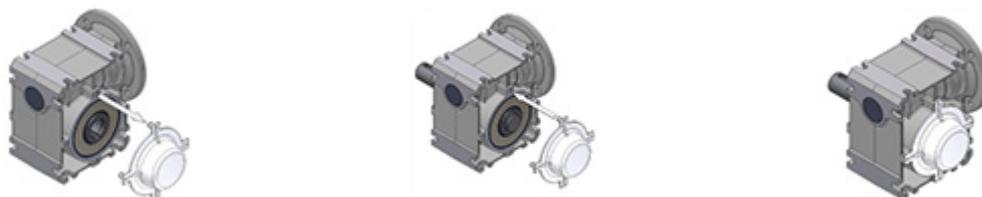
Abbildung 15: Demontage und Montage der Abdeckkappe
