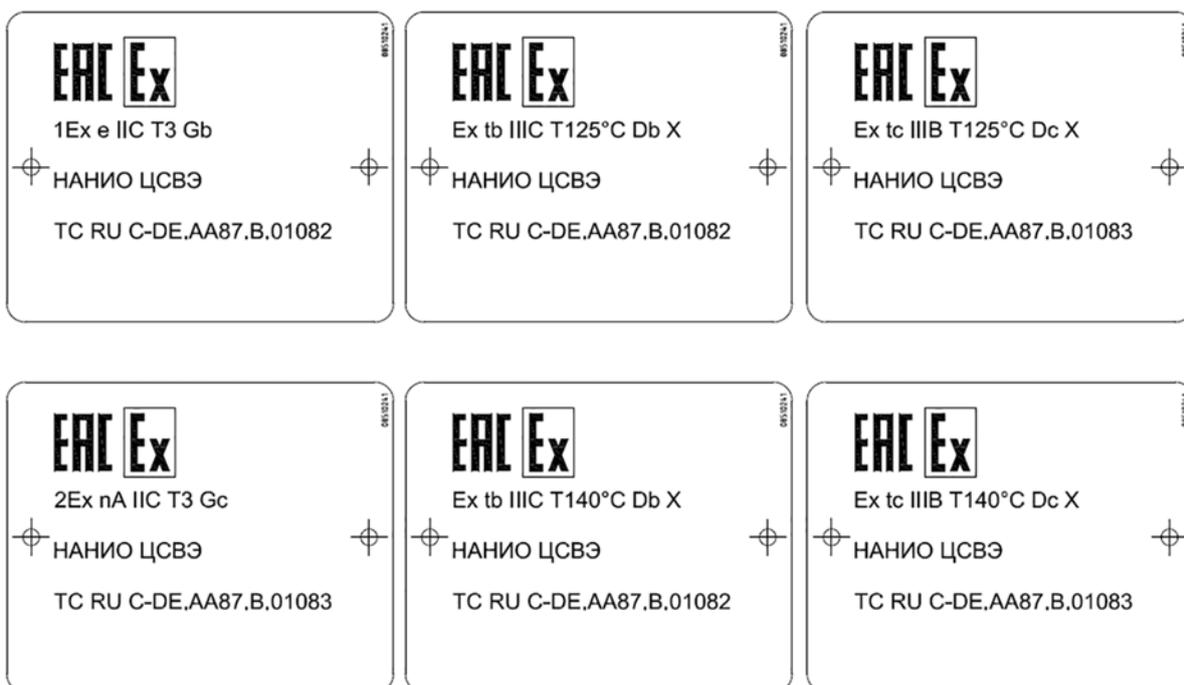
Die Motoren dürfen nur in Bereichen betrieben werden, in welchen die auf dem Typenschild des Motors angegebene Zündschutzart zulässig ist. Zudem ist die auf dem Typenschild angegebene Temperaturklasse sowie die max. zulässige Oberflächentemperatur zwingend zu beachten.
