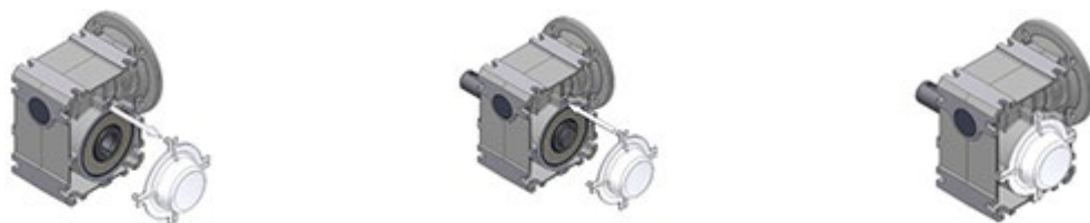
図 14: カバーキャップの脱着
