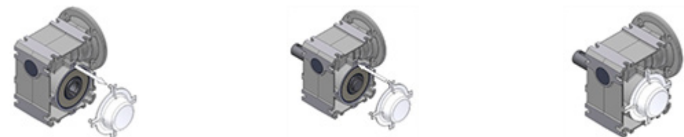
Slika 14: Demontaža in montaža zaščitne kape
