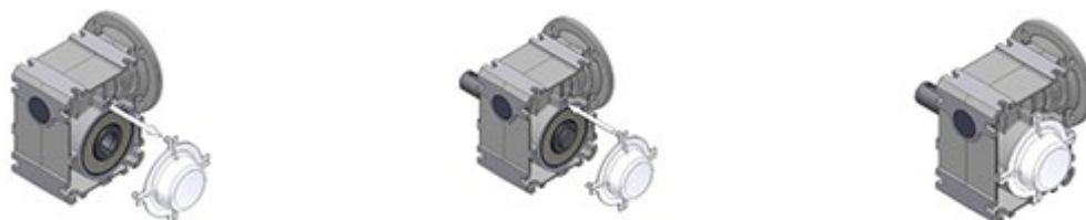
14 pav. Gaubtelio išmontavimas ir montavimas
