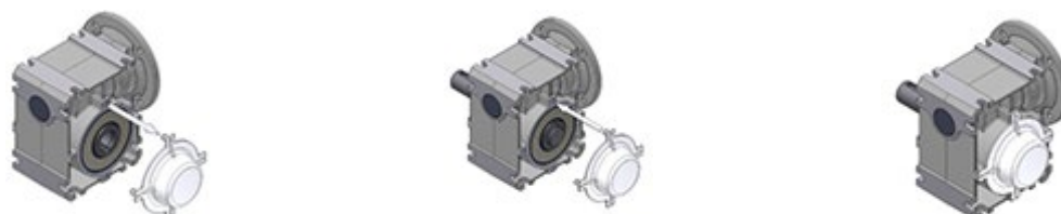
Attēls 14: aizsargvāka demontāža un montāža
