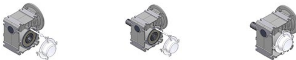
Фигура 14: Демонтаж и монтаж на предпазния капак
