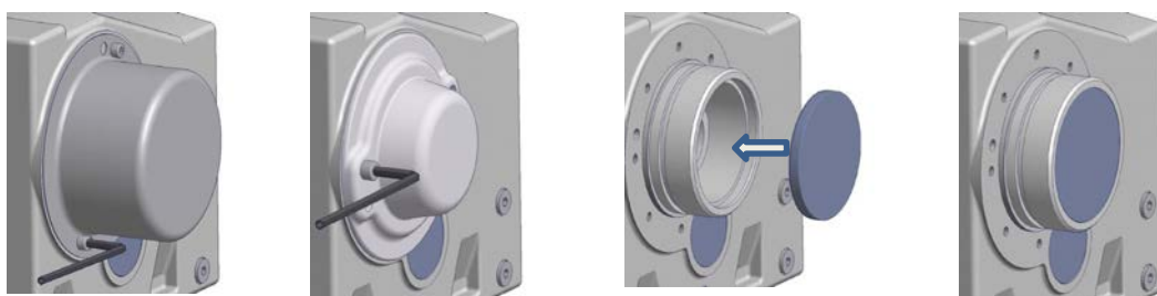
Figura 13: Montaje de la tapa de protección (opción SH, opción H y opción H66)
