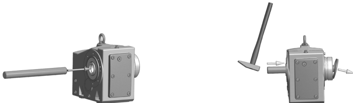
Abbildung 5: Demontage der werkseitig montierten Verschlusskappe
