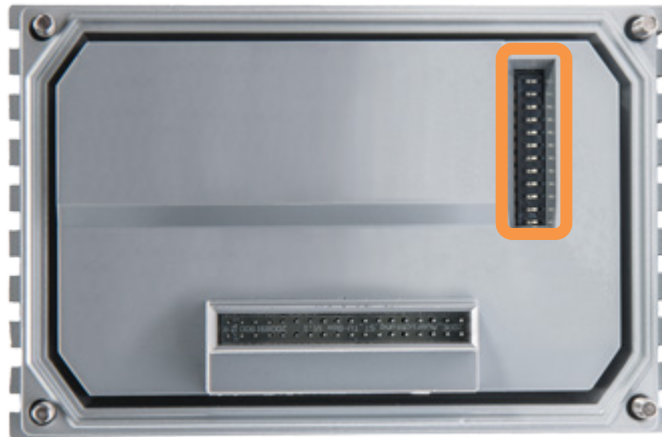
Abbildung 13: SK TU4-PNT: Einstellung Abschlusswiderstand über DIP-Schalter DIP1
