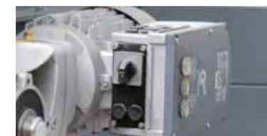
Schalter und Taster sind unmittelbar an den Antrieben angeordnet und erlauben den direkten Start, Stopp sowie Modusänderungen.
